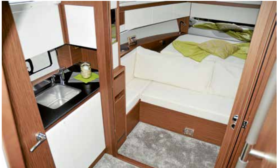
Die Eignerkabine im Vorschiff und die Pantry. Nimmt man die Polster der Sitzbank weg, kann die Doppelkoje durch Ausziehen verlängert werden. Die Bankpolster dienen dann als Kojenauflage (siehe unten).
