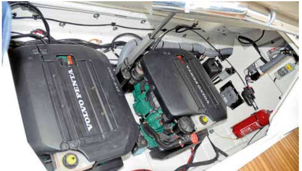
Reichlich Platz für die zwei D3 im blitzsauberen Maschinenraum mit hydraulischer Klappe.
