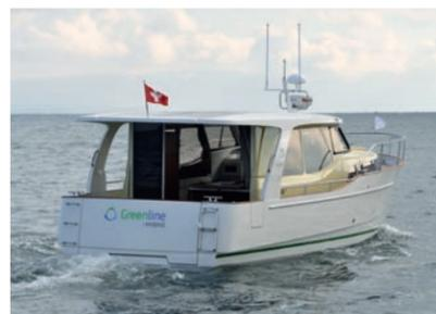
Le Greenline 33 n'est pas sensé proposer de grandes vitesses et des virées incroyables. Il est par contre très agréable à manœuvrer, même si la réactivité du volant pourrait être un peu plus directe. Les deux quilles latérales de la partie arrière de la coque confèrent au bateau une bonne stabilité et protègent l'hélice. La motorisation standard de 75 chevaux est absolument suffisante, du moins sur des eaux intérieures (option: 165 chevaux).
