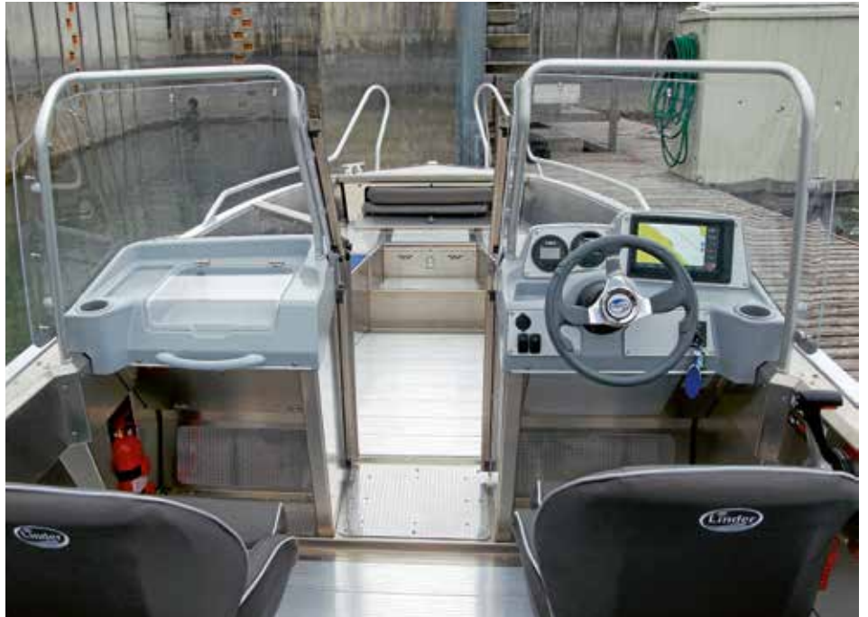
Der Durchstieg zum Vorschiff kann mit einer Türe verschlossen werden, die eine versenkbare Schiene enthält. Der Kartenplotter ist serienmäßig an Bord. Die beiden drehbaren, gasgedämpften Sitze sind verstellbar. Die Stauklappe unter der linken Konsole klappert etwas.
