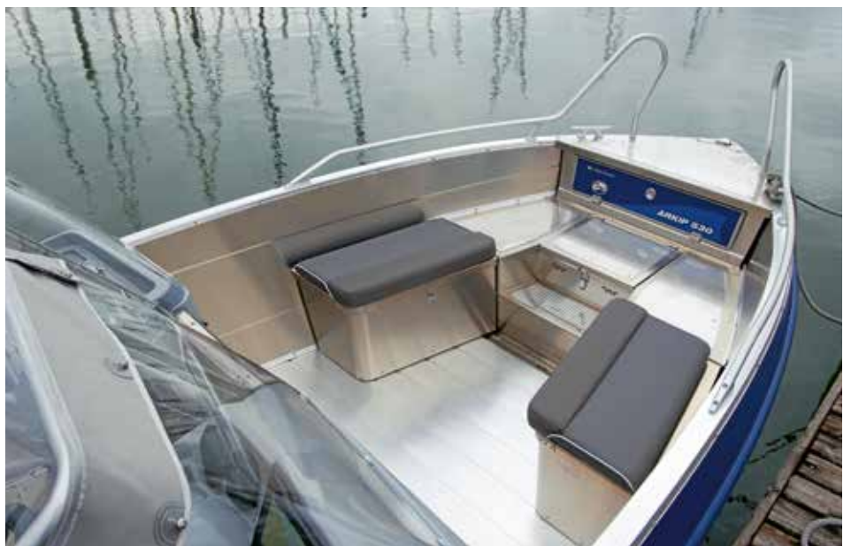
Die beiden gepolsterten Staukästen können entfernt und so auch größere Gegenstände transportiert werden. Der Plichtboden besteht aus rutschfesten Aluminiumprofilen. Der Rumpf ist nicht selbsttlenzend, aber mit einer automatischen Bilgenpumpe ausgestattet. Sehr praktisch sind die beiden Handläufe am Bug. Alle Trittflächen sind mit Warzenblech belegt.
